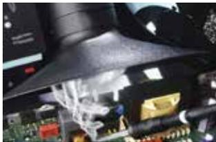
Bleifreies Löten erzeugt bis zu 250 % mehr Partikel in der Atemzone als das Löten mit bleihaltigem Löt. Pro Kubikmeter werden 700 Millionen winzige Partikel ausgestoßen, die in die Lungenbläschen gelangen können.
